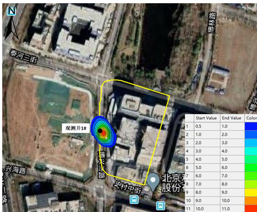
图 7.2-17 调节池废水停止泄漏后 100 天氨氮水平迁移扩散（浓度：mg/L）
