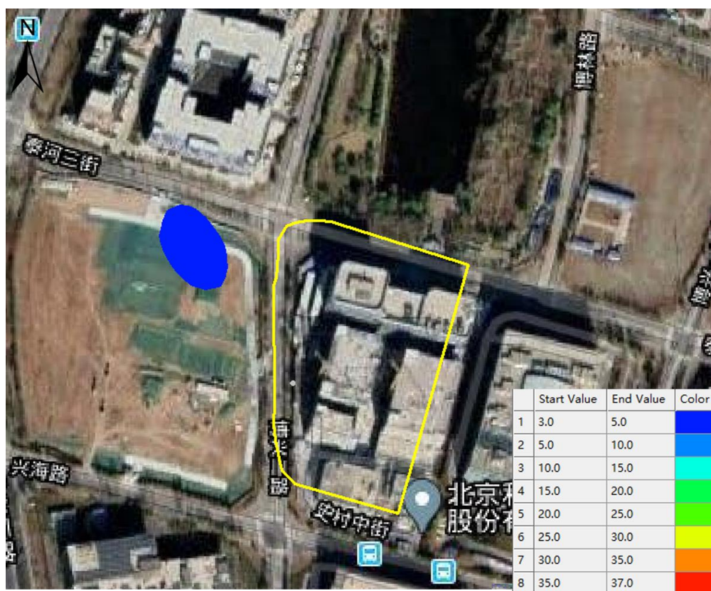
图 7.2-12 调节池废水停止泄漏后 1095 天 COD 水平迁移扩散（浓度：mg/L）
