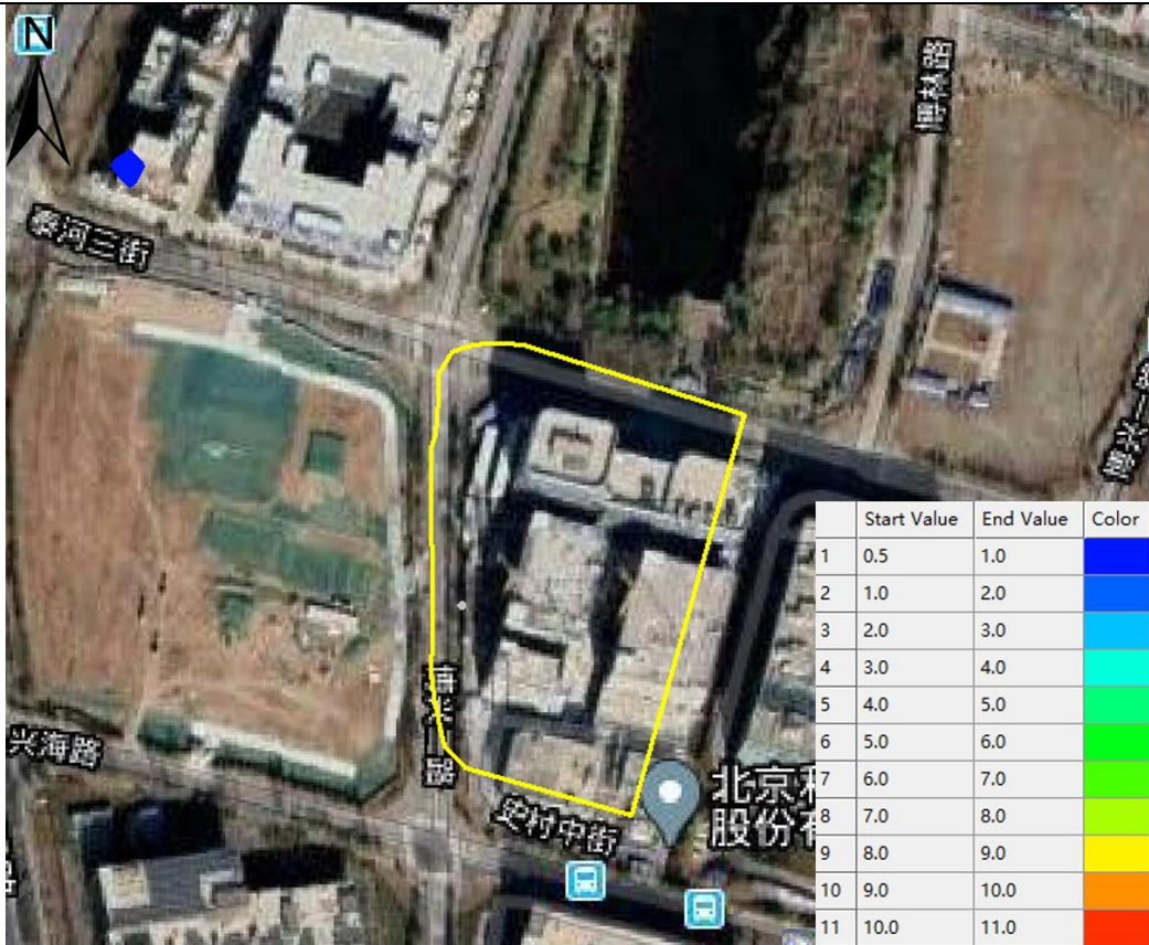
图 6.3-18 调节池废水停止泄漏后 2190 天氨氮水平迁移扩散（浓度：mg/L）
